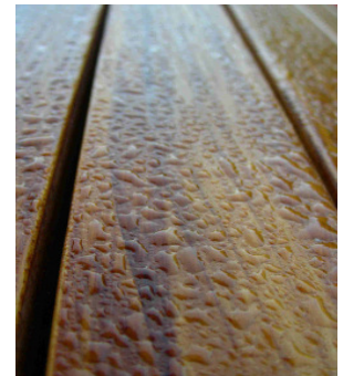
Mit Holzschutzmittel behandeltes Holz.
