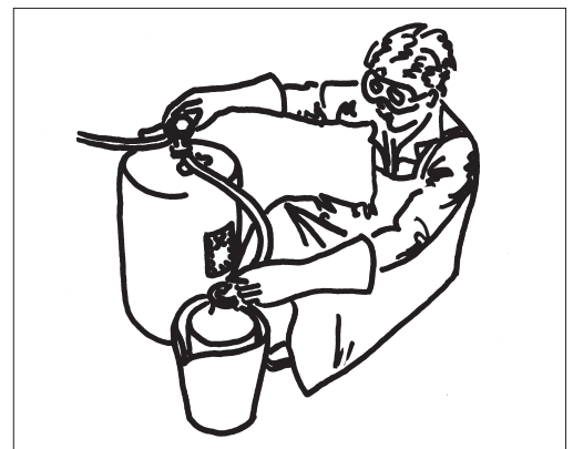
Bild 6: Umfüllen mit Handpumpe.
